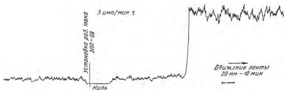
Рис. 28. Запись интегрального счёта без А.С. и с А.С. для пропорционального счётчика в стальном экране
