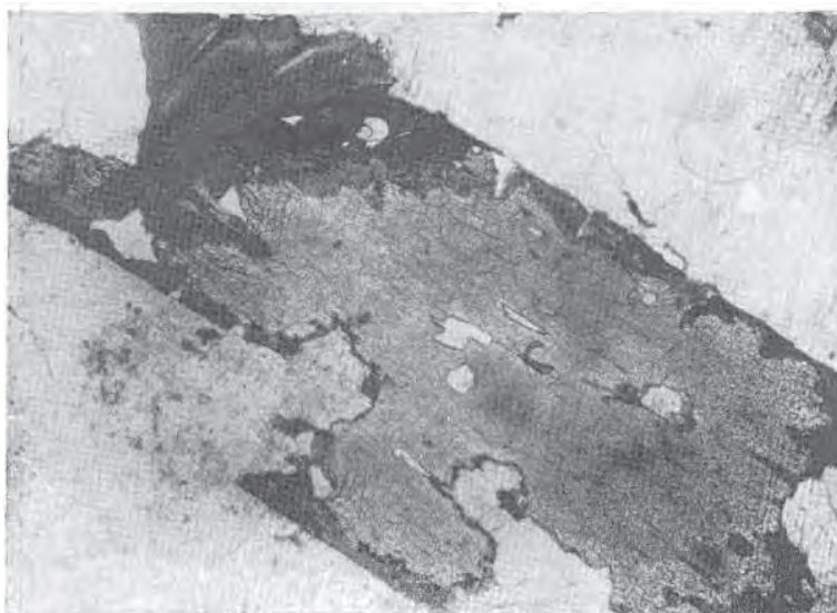
Фиг. 5. Обр. 1280/4, Гора Салтычья. Ортит с каймой изменения, разьедаемый кварцем и ортоклазом. Увел, 46, без анализатора
