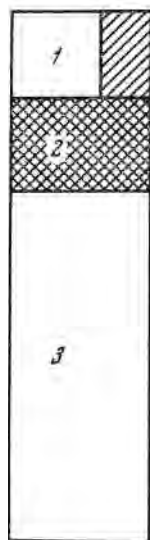
Рис. 1. Схематическое изображение процесса выплавления легкоплавкой фазы по механизму зонного плавления: 1 — выплавленное вещество (легкоплавкая фаза), 2 — расплавленная зона, 3 — остаток, обогащенный тугоплавкими компонентами. Штриховкой условно показана доля легкоплавких компонентов.
